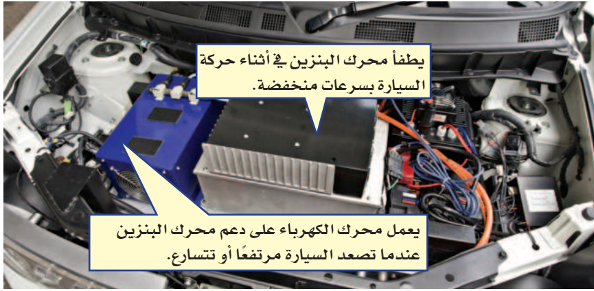
الشكل ٧ السيارات المعتمدة على البنزين والكهرباء - كالتي في الشكل - تقلل من استخدام البنزين؛ فهي تحتوي على محركين: أحدهما يعمل بالبنزين، والآخر بالكهرباء.
